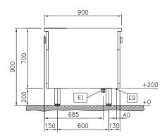
Electrical inlet (power) FΩ Equipotential screw
